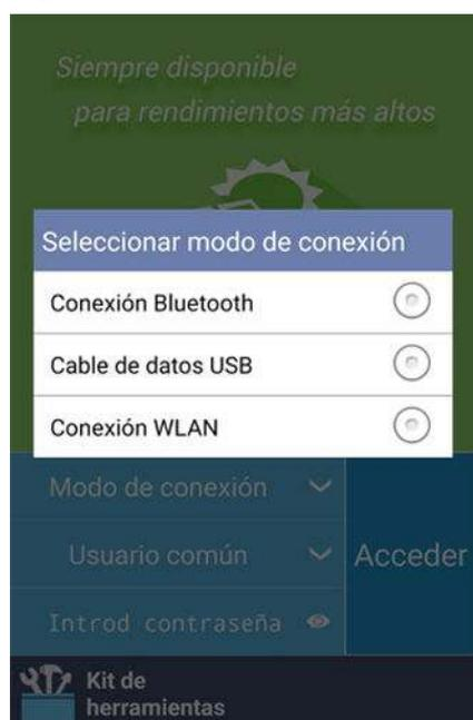
**Paso 4** Pulse el área del nombre de usuario en la aplicación SUN2000 para alternar entre **Usuario común**, **Usuario avanz** y **Usuario esp**.
