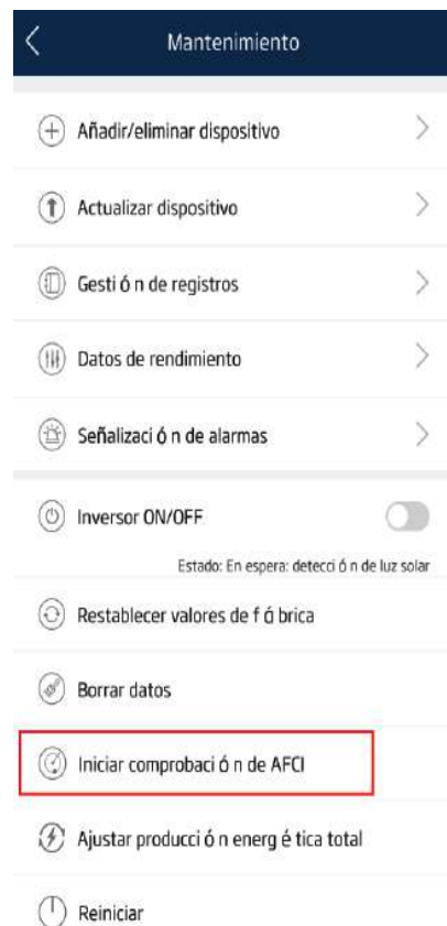
Figura E-1 Inicio de comprobación de AFCI
