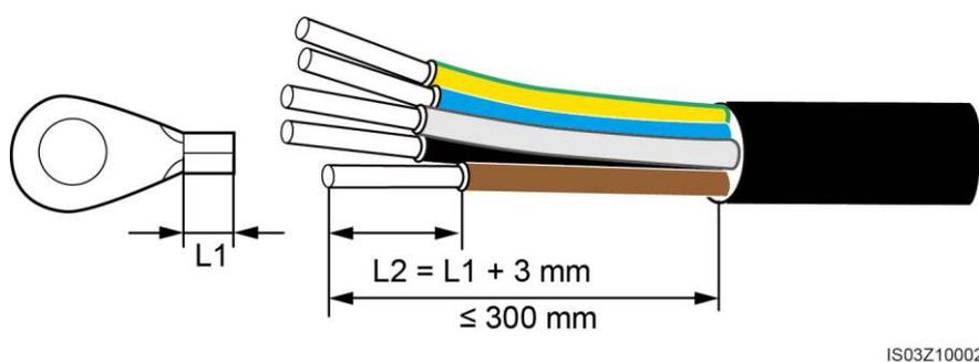
Paso 5 Inserte los núcleos de alambre expuestos en el área de engaste del terminal OT y engástelos usando pinzas hidráulicas.
