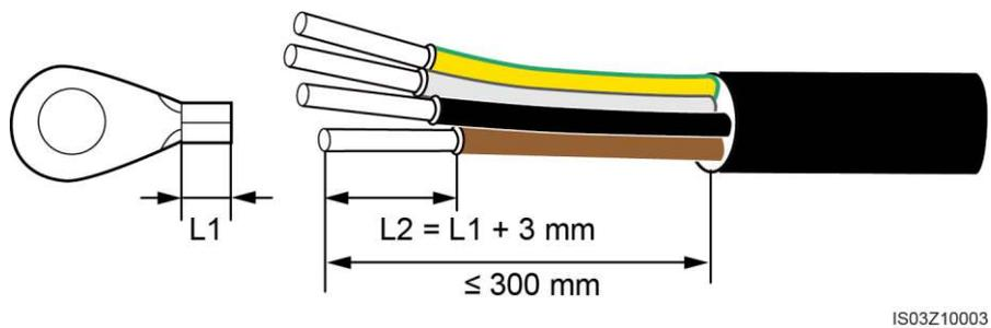
**Figura 5-11** Cable de cuatro núcleos (excluye el cable de tierra pero incluye el cable neutro)
