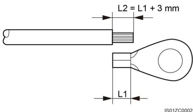
Paso 2 Inserte los núcleos de alambre expuestos en el área de engaste del terminal OT y engástelos usando una pinza hidráulica, como se muestra en la [figura 5-4](#).
