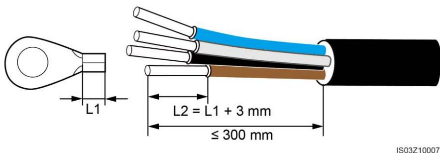
**Figura 5-12** Cable de cinco núcleos (incluye el cable de tierra y el cable neutro)
