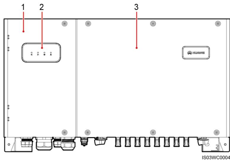
(1) Puerta del compartimento de mantenimiento (2) Indicador LED (3) Panel del host
