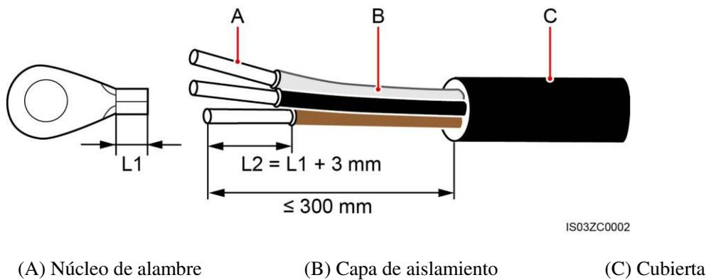
**Figura 5-10** Cable de cuatro núcleos (incluye el cable de tierra pero no el cable neutro)
