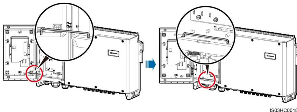
Paso 3 Cierre la puerta del compartimento de mantenimiento. Ajuste los dos tornillos de la puerta del compartimento de mantenimiento usando una llave de tuercas torx de seguridad con un torque de 5 Nm.
