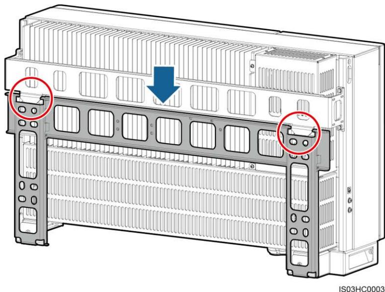
Paso 6 Ajuste los dos tornillos torx de seguridad usando una llave de tuercas torx con un torque de 5 Nm.
