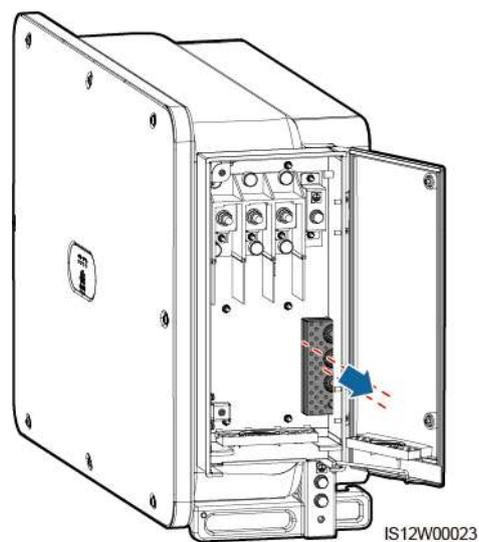
**Paso 3** Seleccione un módulo de crimpado de acuerdo con el tipo del cable de alimentación de salida de CA.
