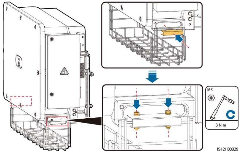
**Paso 2** Coloque los conectores en forma de Y en la bandeja.
