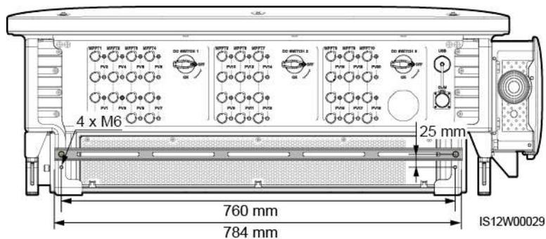
**Paso 1** Instale una viga.
