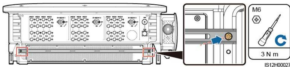
**Paso 2** Ate los conectores en forma de Y en la viga.
