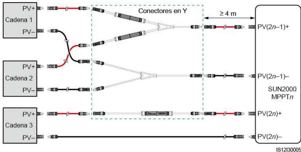
**Figura 5-23** Cómo conectar los conectores en forma de Y al inversor
