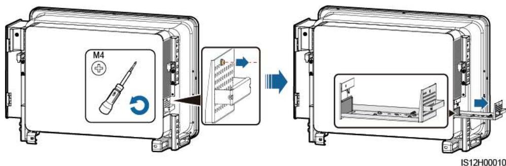
**Paso 2** Retire las abrazaderas compartidas por los cables, desatornille los conectores y desconecte los cables.
