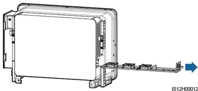
**Paso 4** Quite las abrazaderas para cables del ventilador defectuoso.
