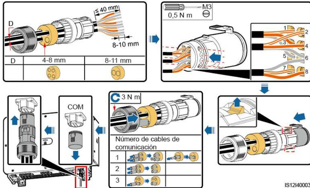
**Figura 5-27** Cómo conectar los cables de comunicación RS485 (tapón de goma con dos o tres orificios de 4–8 mm)
