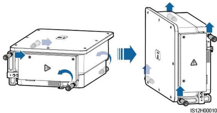
**Paso 3** Si el lugar de instalación está demasiado alto para instalar el inversor sobre el soporte de montaje, coloque una cuerda que sea lo suficientemente fuerte como para soportar el inversor a través de los dos orificios de elevación y levante el inversor.
