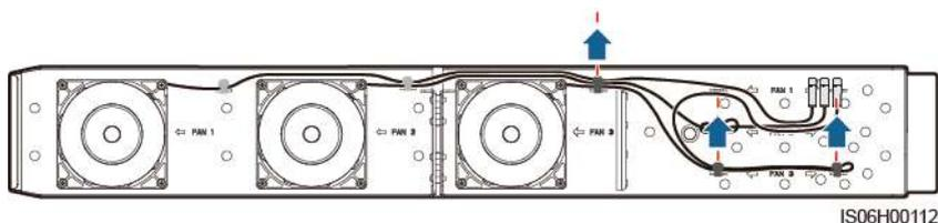
**Paso 5** Extraiga el ventilador defectuoso (el ventilador 1 se utiliza como ejemplo).
