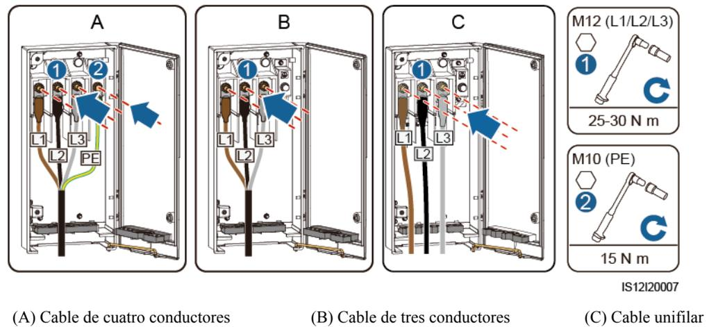
(A) Cable de cuatro conductores
