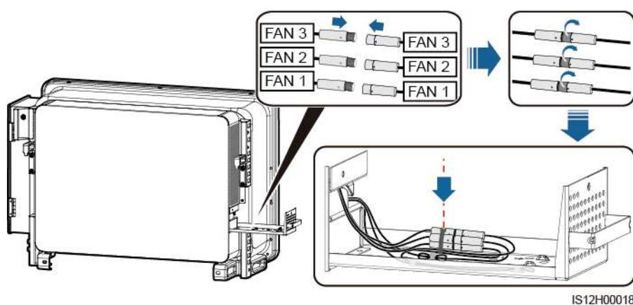
**Paso 10** Inserte la bandeja de ventiladores en la ranura y ajuste los tornillos.
