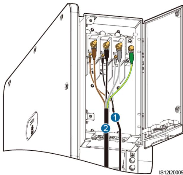
(1) Cable de alimentación del sistema de seguimiento      (2) Cable de alimentación de salida de CA
