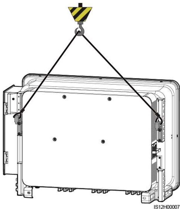
**Paso 4** Instale el inversor en el soporte de montaje y alinee la caja del inversor con este mismo soporte.
