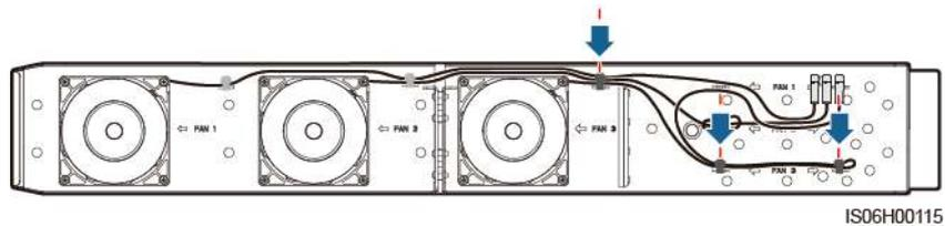
**Paso 8** Inserte la bandeja de ventiladores en la ranura hasta que la placa deflectora quede alineada con el chasis del inversor.
