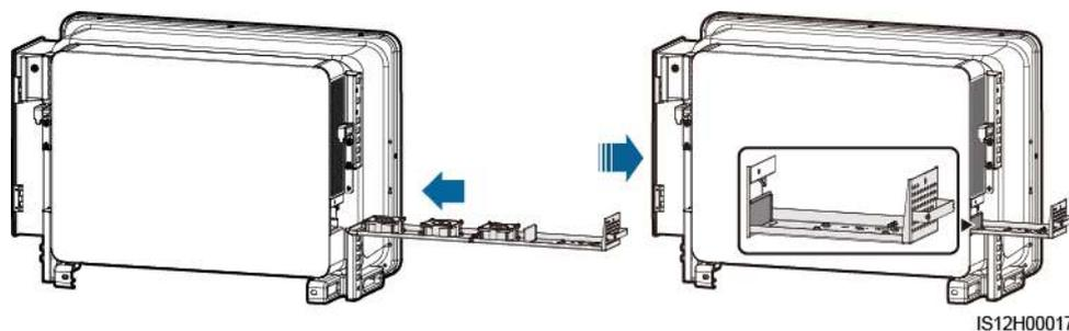
**Paso 9** Conecte los cables correctamente de acuerdo con las etiquetas de los cables y átelos.
