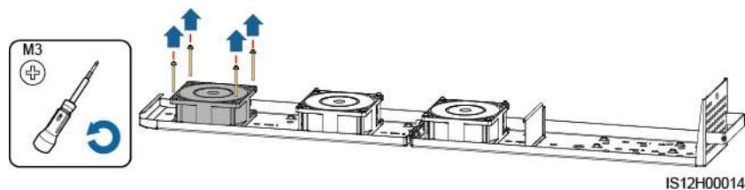
**Paso 6** Instale un ventilador nuevo (el ventilador 1 se utiliza como ejemplo).
