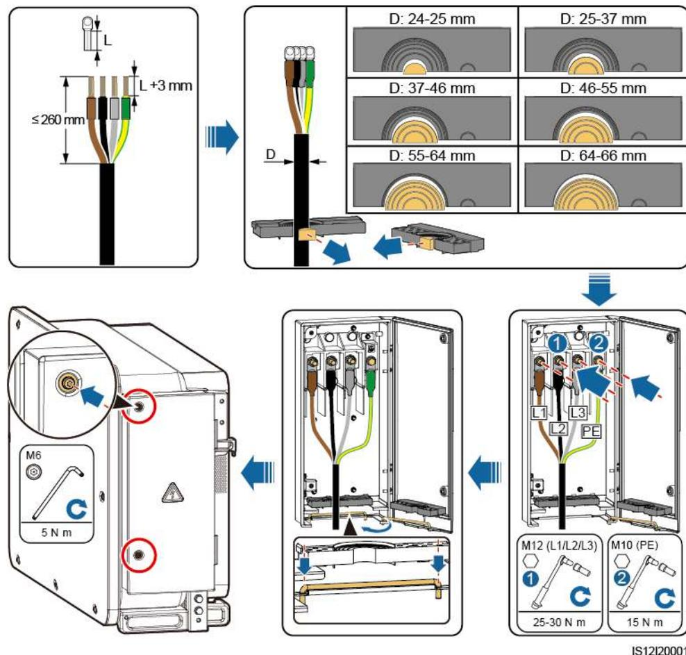
**Figura 5-17** Conexiones de cables unifilares
