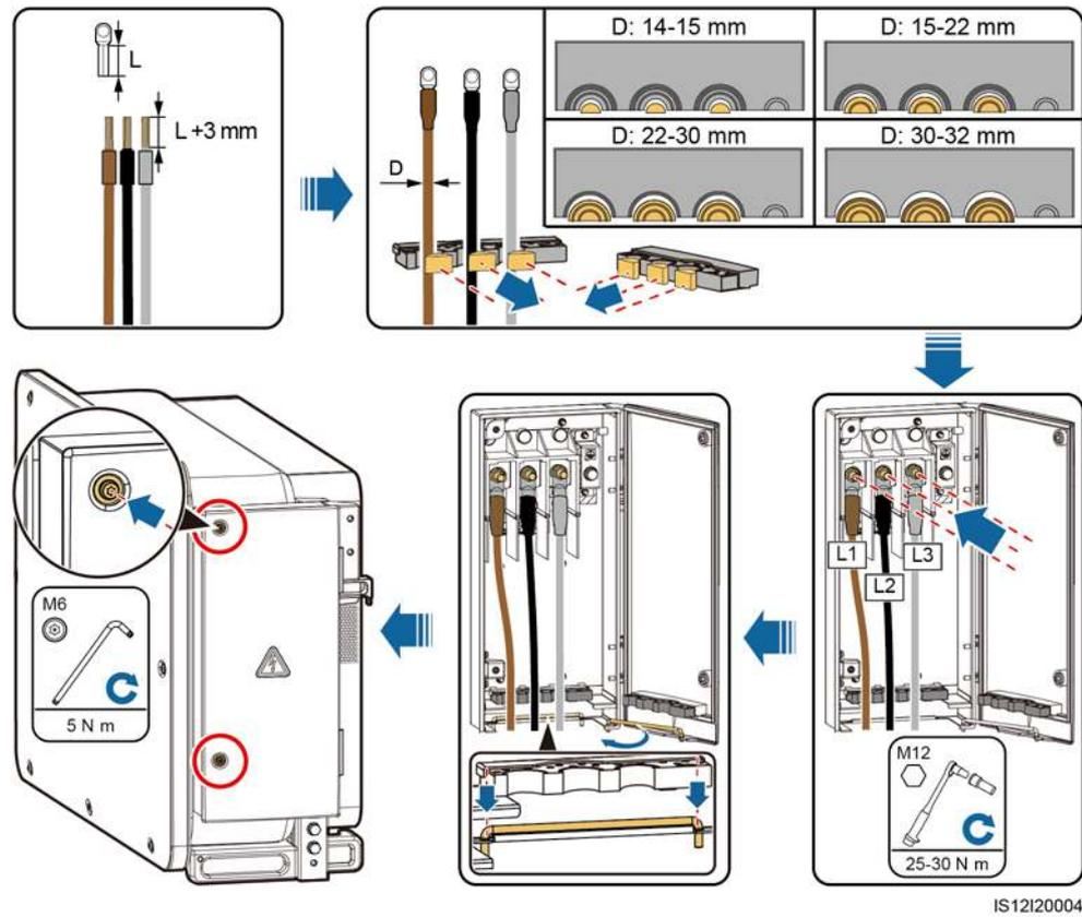
**Figura 5-18** Conexiones de cables del modelo de 3 PIN (125KTL)
