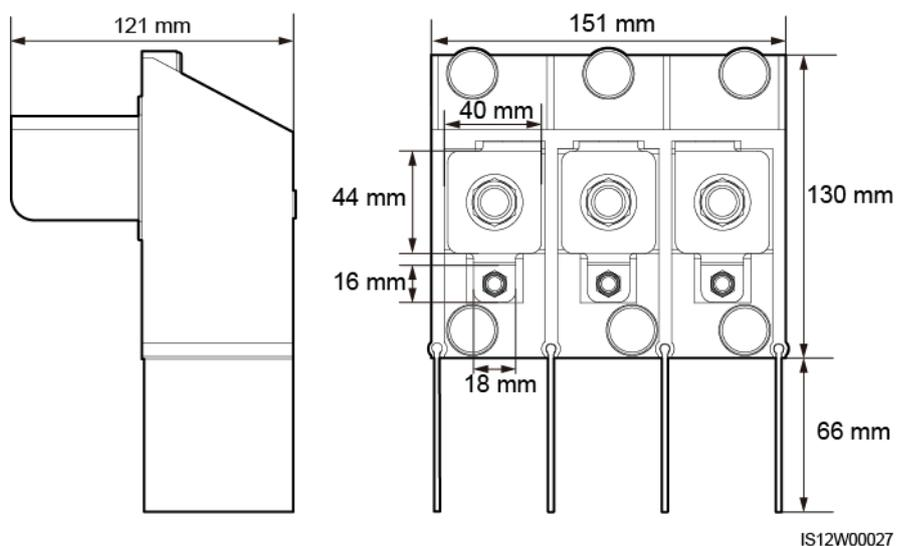
**Figura 5-15** Dimensiones de la regleta de conexión de CA del modelo de 4 PIN
